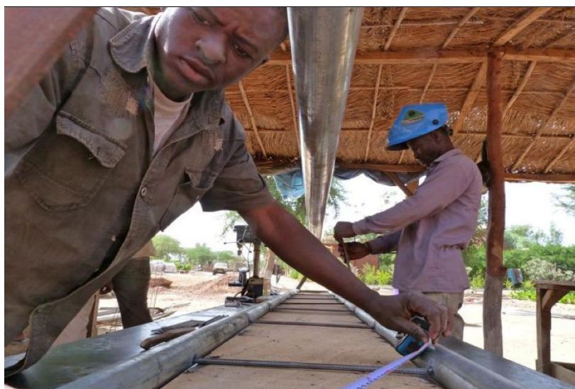
Jean (links) die de nieuwe vakwerktoeren aan het maken is. Bamoye (rechts) helpt hem hierbij.
